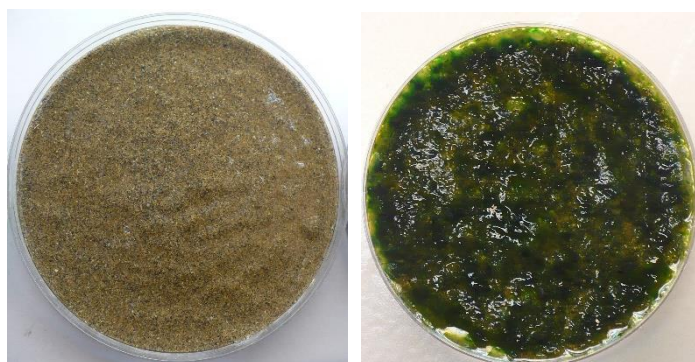
شکل ۱ تصویر لایه زیستی تشکیل شده سیانوباکتری میکروکولئوس بر سطح خاک در مقایسه با آزمایش کنترل
